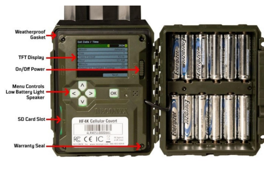
카메라 내부 - TFT 디스플레이, 조작 버튼, SD카드 슬롯 및 AA 배터리 12구
